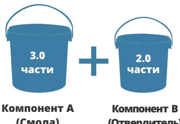
Компоненты А и В предварительно дозированы. Температура компонентов при смещивании должна быть 15-20°C. Более высокие значения температуры существенно снижают срок использования приготовленного состава.
